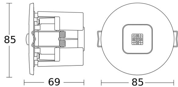
Possibile altezza di montaggio: 2,00 m - 5,00 m
